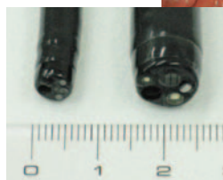
経鼻内視鏡(左)はカメラの径が約5mm、通常の内視鏡は約10mm
