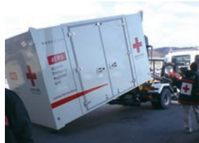
コンテナ降ろし作業 フックロールと呼ばれるアームでコンテナを降ろします
