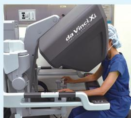
画像を見ながらロボットを遠隔操作します
